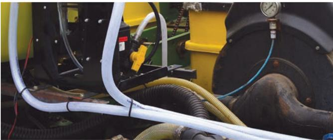
**f** Si désiré: Ajouter un commutateur à deux voies pour être capable d'activer et d'éteindre le mélangeur; **installer un fil électrique 12 Volt** depuis le tracteur jusqu'au moteur électrique du mélangeur. S'assurer que le moteur **fonctionne en tout temps** lors de l'utilisation du Système d'injection liquide AGTIV®.
