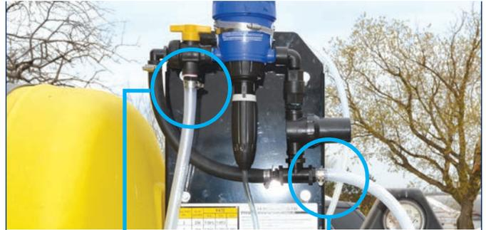
**1** un depuis le débitmètre de votre système existant d'application dans le sillon jusqu'à la **valve jaune principale** du système d'injection.
